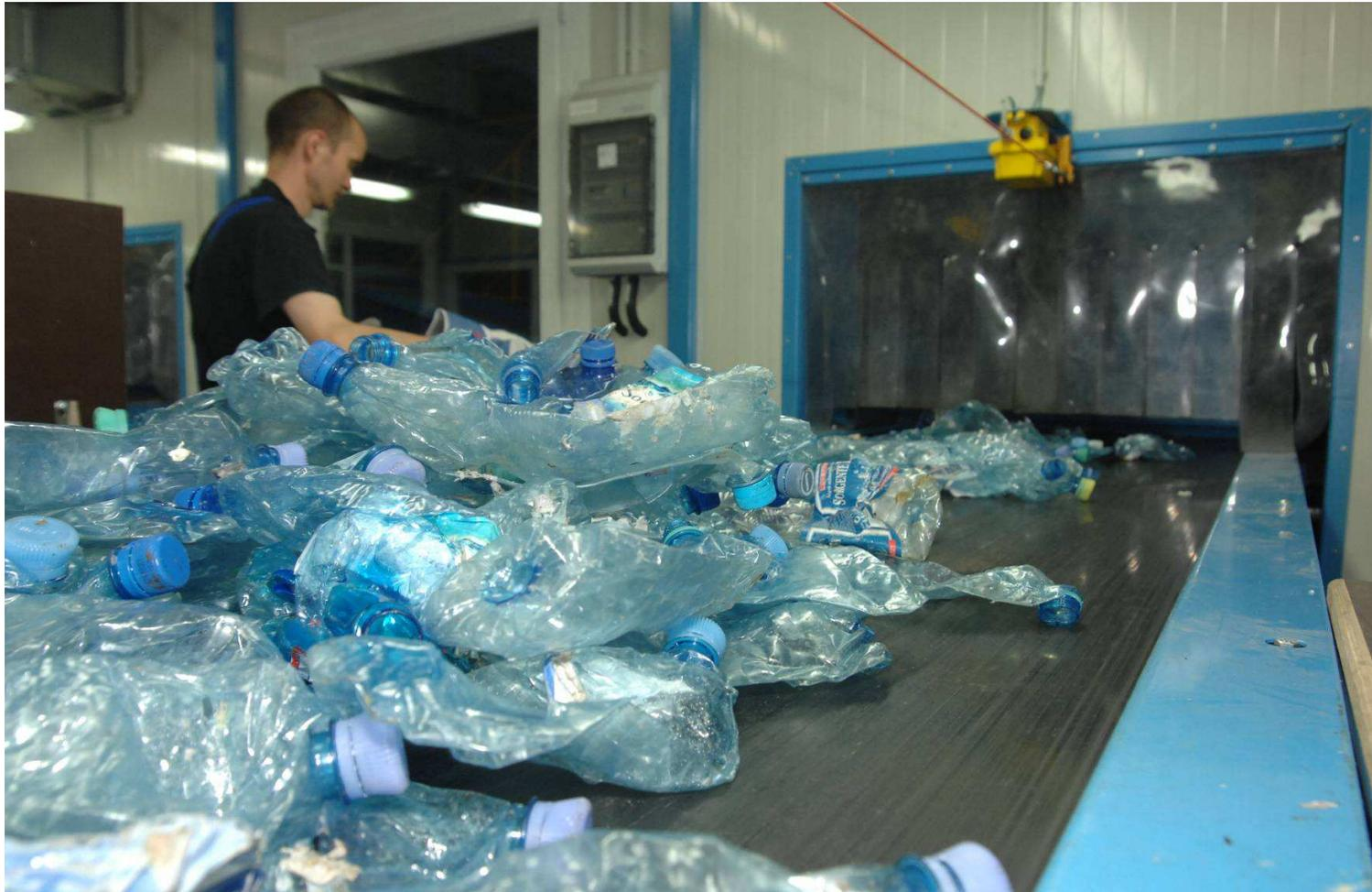
Visuelle Kontrolle um die Produktreinheit zu erhöhen (+ 2 bis 3 %)
