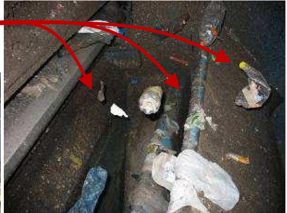
Materialseparation erfolgt mittels Druckluftdüsen (Steuerung der Wurfparabel)
