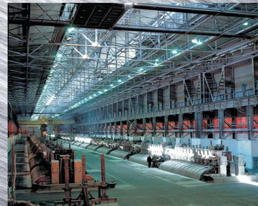
В настоящее время в промышленных масштабах для электролитического производства алюминия в качестве электролита применяют *расплав криолита* ( $\text{Na}_3\text{AlF}_6$ ), содержащий растворенный *глинозем* ( $\text{Al}_2\text{O}_3$ ). В качестве материала анода в современных промышленных электролизерах используется *угольный анод*.
