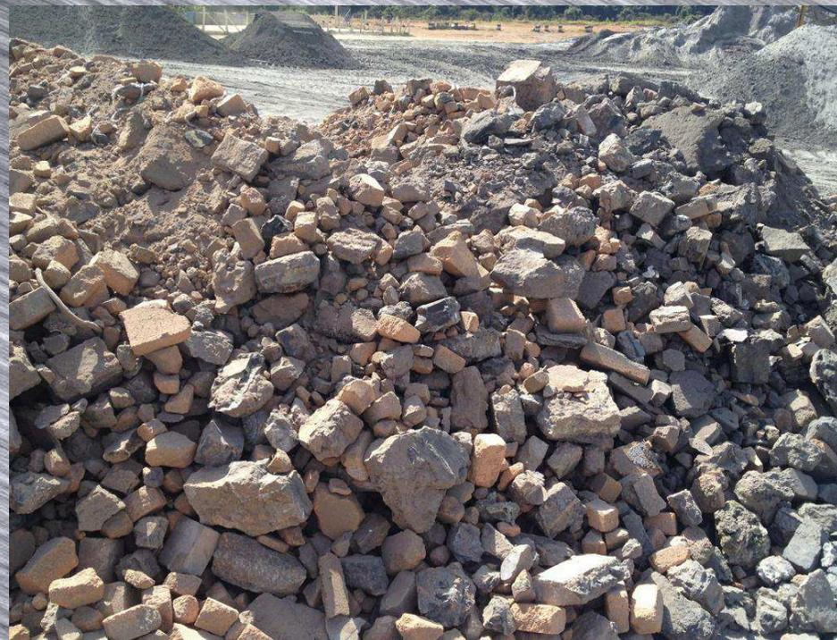
Отработанная огнеупорная футеровка алюминиевых электролизеров (Бразилия))
