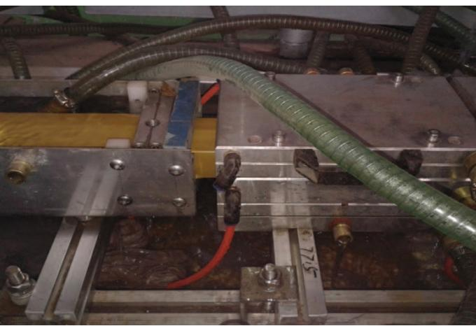
Рисунок 2. Выход материала из калибратора в охлаждающую ванну
