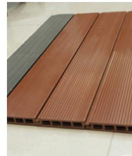
Рисунок 7. Образцы монтажной лаги из ВИНИЗОЛа
